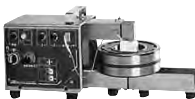
Индукционный нагреватель для подшипников (кат. E398)
